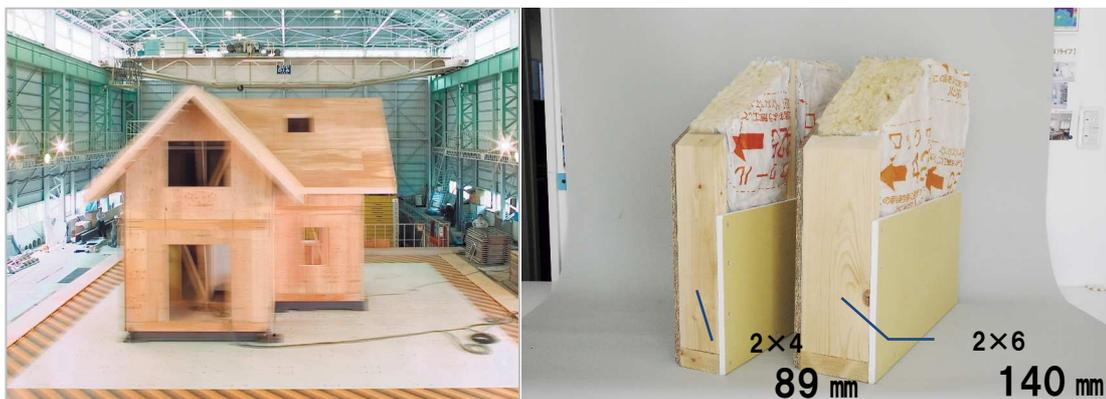
《左:制震システムの実物大振動実験の様子 右:2×4工法と2×6工法の断熱材の厚み比較》
